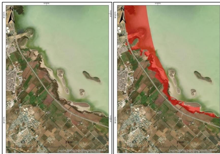
**Figure 5 :** Berges de la rive sud-ouest de Sebket Séjoumi (zone agricole de Sidi Hassine) : état naturel actuel (à gauche) et projection si le PAV est mis en œuvre avec leur remblaiement quasi-total (à droite).
